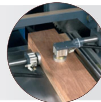
Tête de perçage pour fenêtre à assemblage mécanique
