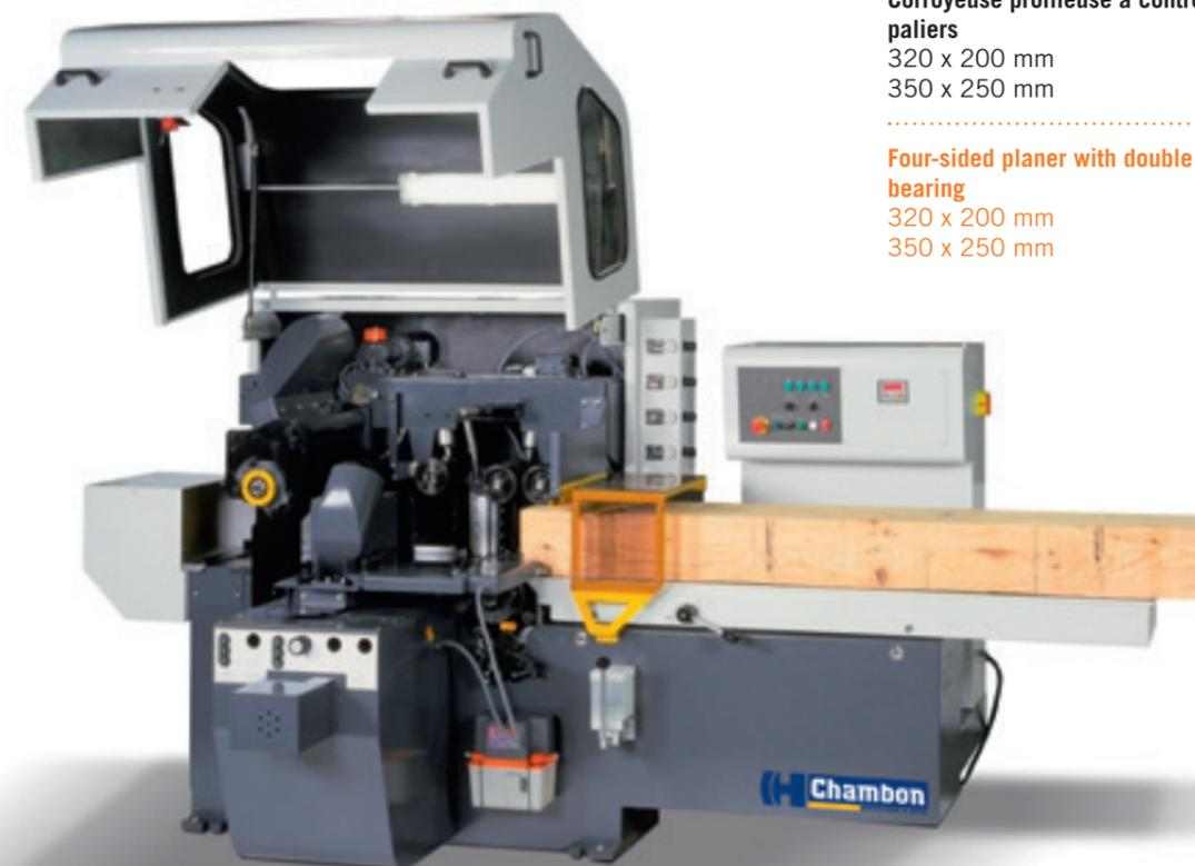
**Corroyeuse profileuse à contre paliers**
