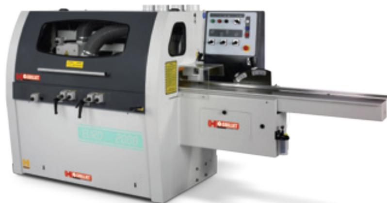
**Corroyeuse profileuse moulurière**
